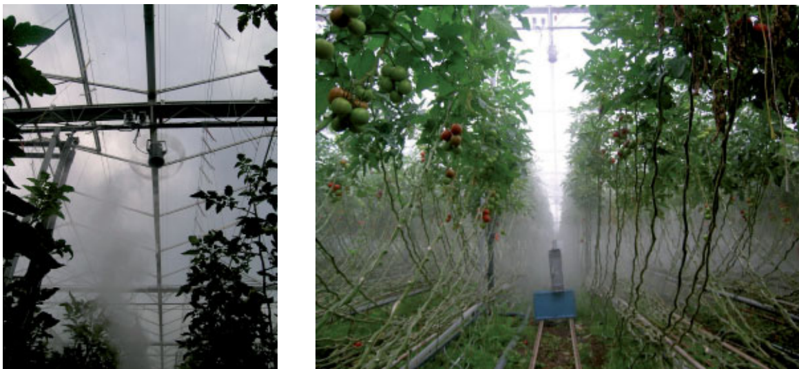
Figuur 28. Rook wordt onder de Aircobreeze aangezogen in een kolom (links) en vervolgens over een groot oppervlak egaal verspreid (rechts).
