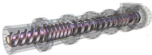
Figuur 2: Barrel (schacht) van de extruder met Archimedes schroef (zie ook figuur 3, nummer 4)
