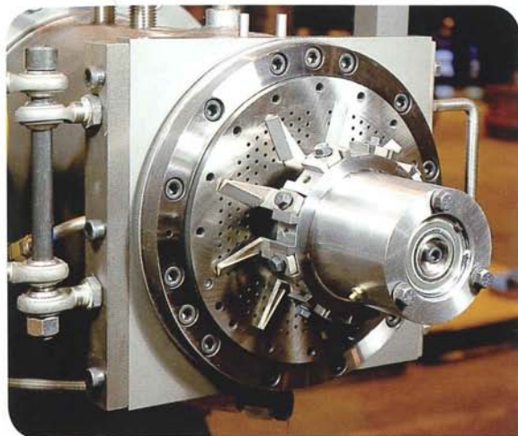
Figuur 1: Matrijs met draaiende messen om de korrels af te snijden (zie ook figuur 3, nummer 5)
