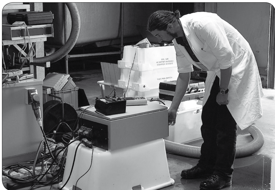
Instellen van het apparaat voor het elektrisch bedwelmen van vis.
