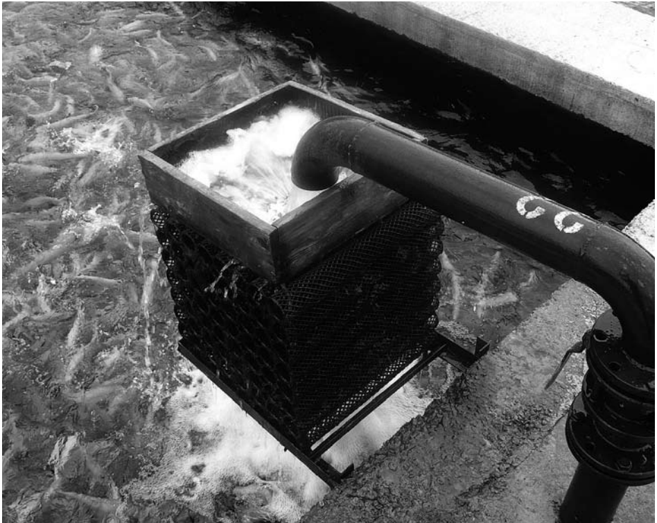
Foto 3. Stripping van het water met behulp van bioblokken
