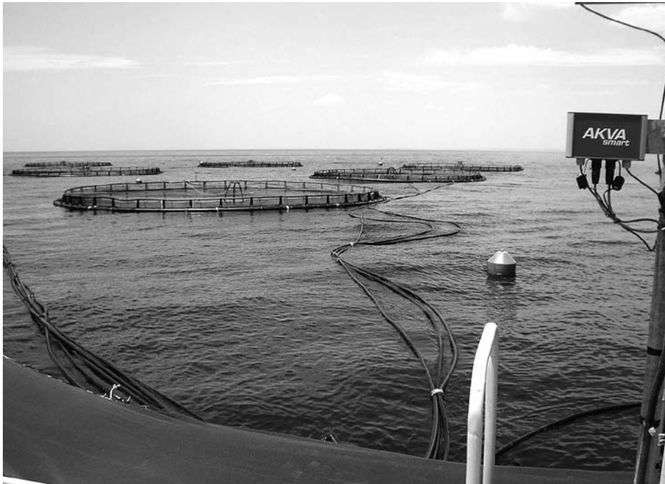
Vanaf het ponton lopen slangen waardoor naar elke kooi een afgepaste hoeveelheid voer geblazen kan worden.
