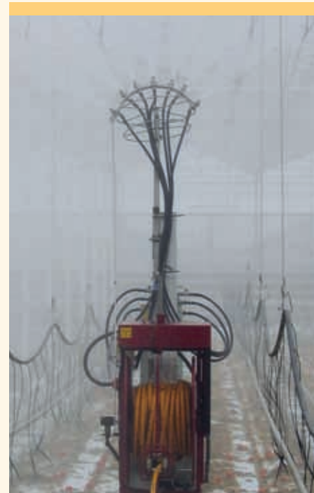
De robots werken bij een druk van maximaal 150 tot 170 bar.
