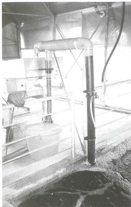
◆ Airlift om paling stressloos in de sorteermachine te krijgen
