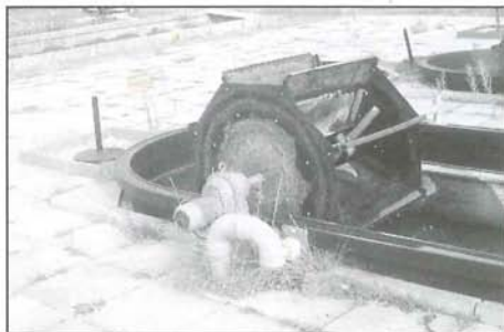
◆ Detailopname van het paddlewheel nodig voor een goede homogenisatie van mest en algen.
