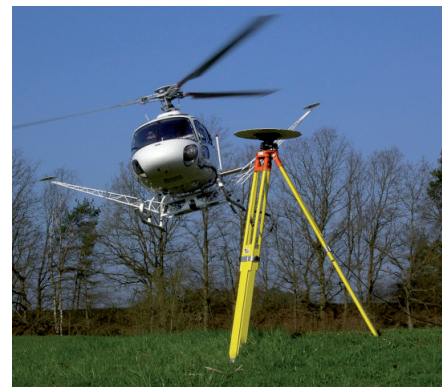
Helikopter en laseraltimetriesysteem in rek; twee GPS-ontvangers op masten aan weerszijden zorgen voor een betere positie- en standbepaling, het GPS-basisstation op de grond zorgt voor een differentieële positiebepaling.
