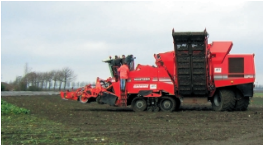
Draaicirkel wordt niet beperkt door rupsen.
