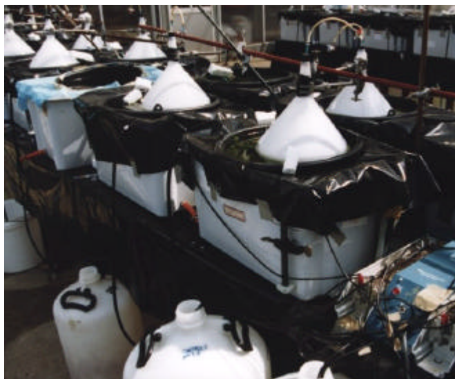
Figuur 3.4: Illustratie opstelling kasexperiment met de buitenbakken, binnenemmers, voorraadvaten met medium en de pompen. Op moment van opname werd de methaanemissie gemeten met behulp van omgekeerde trechters.
