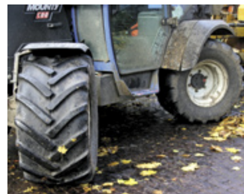
De MOUNTY heeft veel besturingsmogelijkheden: hondengang, vierwiel- en achterwielbesturing.
