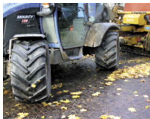
De MOUNTY heeft veel besturingsmogelijkheden: hondengang, vierwiel- en achterwielbesturing.
