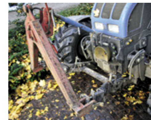
De fronthef zit op de vooras. Het werktuig volgt hiermee goed het terrein.
