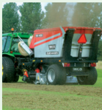
De Trilo kan worden gecombineerd met een zuigmachine. Die werkt snel en schoon. Wordt het vilt gestort dan is het aantrekkelijk om het een paar uur te laten drogen voor het opruimen. Dat scheelt aanmerkelijk in de kilo's. De Trilo zuigwagen kan ook prima los van het verticuteren worden ingezet en is daardoor flexibel inzetbaar.
