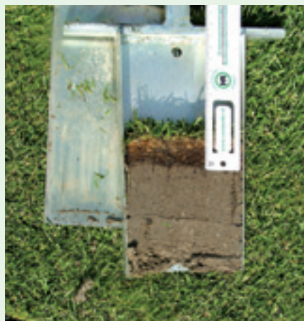
Goed afstellen is een voorwaarde voor goed verticuteren. Dat is millimeterwerk en alleen goed te controleren door een profiel te steken. De rotors moeten net door het vilt heen snijden. Ondieper beperkt het effect, dieper maakt onnodig veel materiaal (grond) los.
