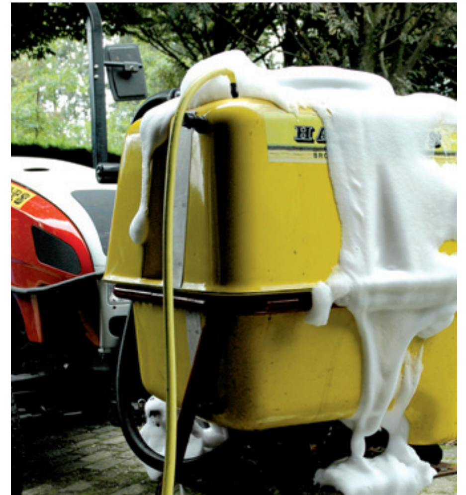
In deze toepassing wordt er een halve liter Prograss Primer op 200 liter water toegevoegd. De machine doseert 360 liter water per 500 vierkante meter. Het goedje wil ook wel schuimen bij het vullen dus het is een beetje opletten wanneer de tank echt vol is.
