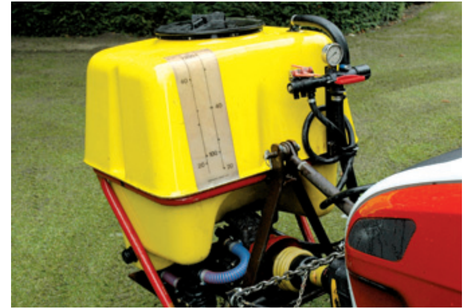
Het systeem van Aerts werkt onder lage druk. Een gewoon membraanpompje volstaat daarom.
