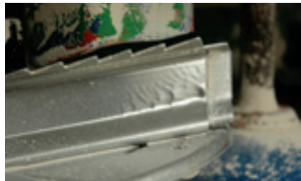
De conditie van de strooier, bijvoorbeeld de strooischoppen is van grote invloed op de nauwkeurigheid. Deze schoep vertoont het begin van slijtage, maar pas bij groeven dieper dan 2 mm is vervangen noodzakelijk. Ook het aankoeken van stof kan het strooibeeld verstoren.
