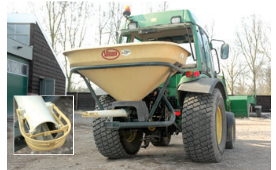
Een pendelstrooier is prima geschikt voor de golfbaan. Het strooibeeld is tamelijk ongevoelig voor fouten in de rijafstand, kanten zijn goed te strooien en de kunstmest vliegt minder ver naar achter dan bij een centrifugaalstrooier. Belangrijk voor een goed strooibeeld is de beugel op het eind van de pijp. Een kleine afwijking heeft al een grote invloed op het strooibeeld.
