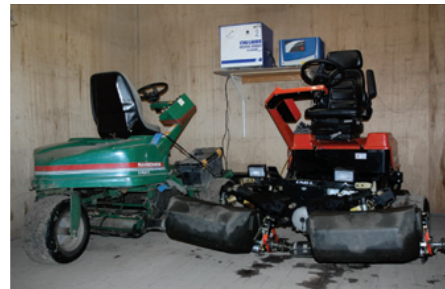
Na het maaien gaat een E-plex meteen aan de lading. Die staat dan een halve dag later weer volgeladen gereed. 18 tot 20 holes is het maximum dat de maaier met een volle accu aan kan.
