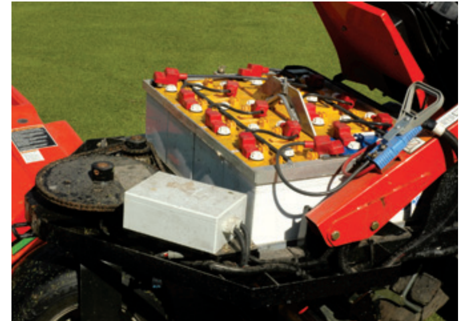
De accu is het hart van de machine. De capaciteit is krap bemeten en dat is vooral voor banen met veel hellingen en grote afstanden een belangrijk bezwaar.
