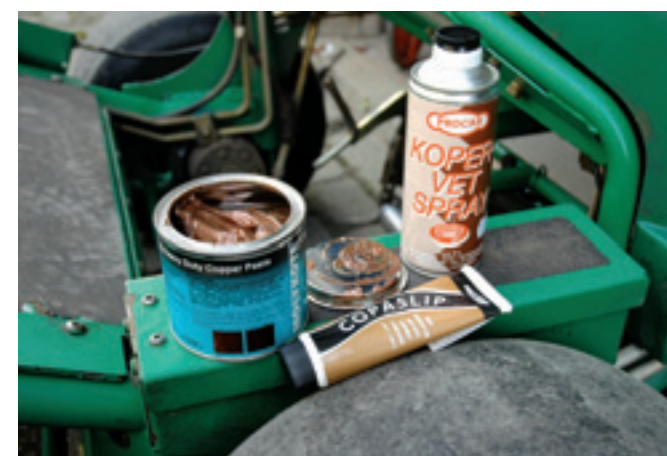
Heel specifiek is kopervet. Het is te koop in een blik, een tube en zelfs in een spuitbus. Kopervet blijft goed soepel en wordt daarom veel gebruikt voor schroefdraad van moeren en bouten die nog wel eens makkelijk vast gaan roesten. Door sap van het maaisel is dat zeker bij messenkooien gauw het geval. Ook wielbouten worden vaak met kopervet ingesmeerd (voor montage).
