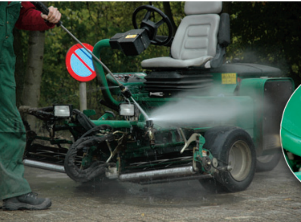
Lagers en draaipunten moeten goed in het vet zitten. Pas op met schoonspuiten. Een hogedrukreiniger kan lagers, keeringen en elektronica beschadigen. Na schoonspuiten weer smeren.
