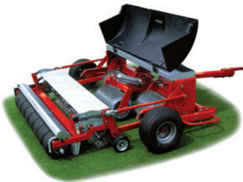
De Wiedenmann Terra Combi combineert doorzaaien met een spijkerrol. De machine is modulair gebouwd en kan ook worden uitgerust met rotors met messen om te beluchten of te verticuteren.
