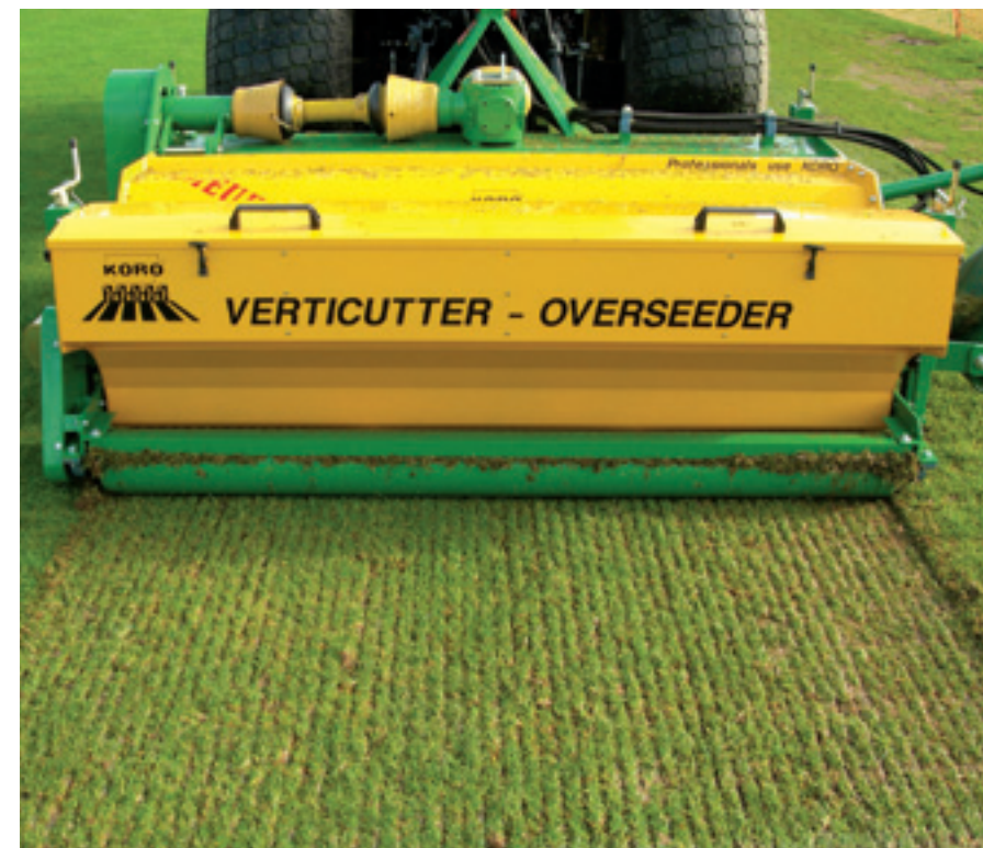
De Koro Verticutter-Overseeder combineert verticuteren met doorzaaien en wordt momenteel ontwikkeld voor het doorzaaien van sportvelden. Het is echt een capaciteitsmachine die ook potentieel heeft voor het verticuteren en doorzaaien van de fairway.
