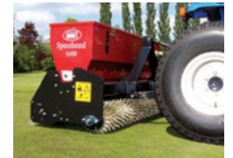
Breedwerpig zaaien met een prikrol doen de Speedseed en Proseed van Redexim, maar ook de Wiedenmann Terra Combi en de Blec Multiseeder. Nadeel van deze techniek is dat graszaadjes minder nauwkeurig in de grond komen. Fijne zaden, als struisgras, komen vrij gemakkelijk in de gaatjes terecht, maar voor langwerpige zaden, als roodzwenk of Engels raai gras, is de methode minder geschikt.
