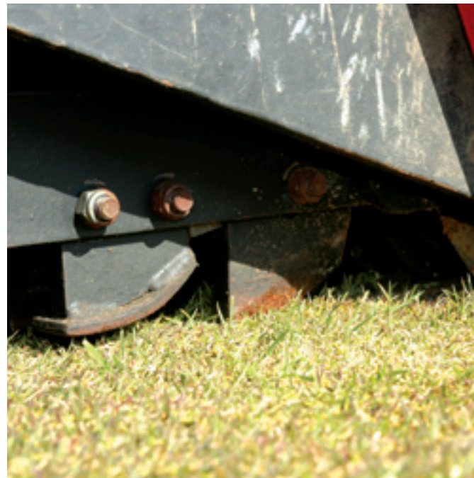
Zeker voor de greens is de Vertiseed van Redexim een veel gebruikte machine. Compact gebouwd en met een goed resultaat (zie openingsfoto). Het ideale principe om in een grasmat door te zaaien: een sleufje snijden, daar de zaadjes in leggen en weer netjes aandrukken.
