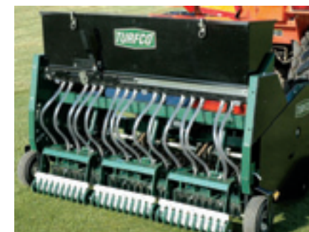
De Turfco TriWave is een Amerikaanse machine die in Europa nog niet heeft gedraaid. De TriWave is vooral gericht op tee's en de fairways. Het bijzondere aan de machine zijn vooral de drie onafhankelijk van elkaar bewegende groepen elementen voor optimale bodemvolgving.
