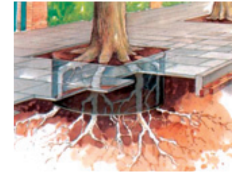
Wortelopdruk, dikke wortels onder het gras (links), voorkomen kan goed bij nieuwe aanplant door een ring van DeepRoot platen te plaatsen (rechts).
