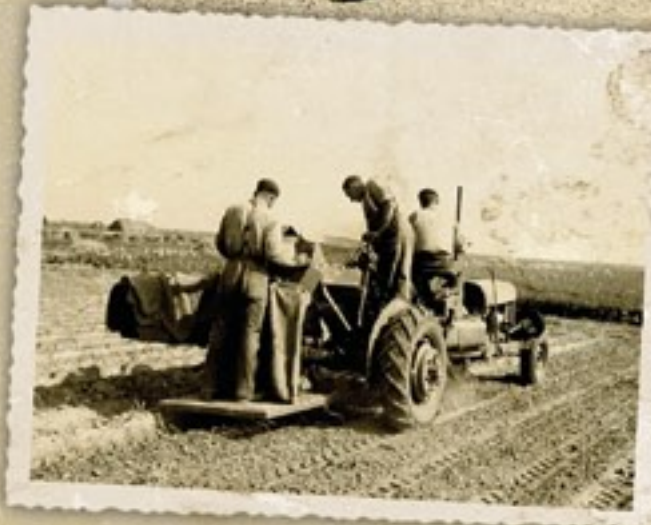
Deze zelfbouw zelfrijdende aardappelrooier was voorzien van een toerenvariator op de rooiketting.
