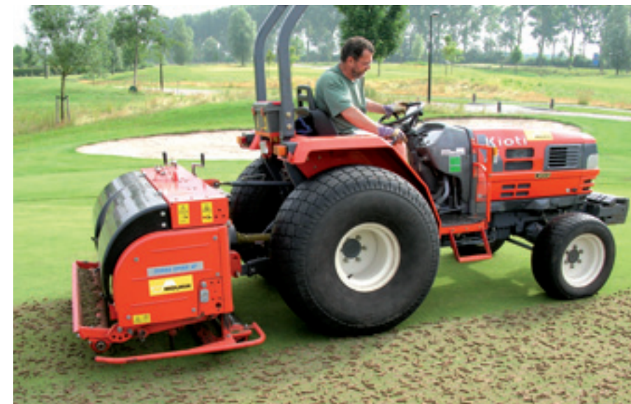
Holprikken en daarna invegen is een manier bij uitstek om een behoorlijke hoeveelheid zeolieten in de grond te brengen. Wordt de behandeling later herhaald dan loop je wel steeds meer risico ook weer zeoliet uit de grond te halen.
