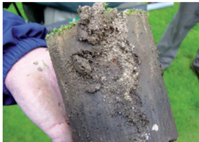
De DryJect is een machine die door Arwin Verschoor wordt geïmporteerd. Zoals de naam al zegt injecteert die droge materialen in de grond, tot 20 cm diep. En dat kan ook een zeoliet of een mengsel van zand met zeolieten zijn.
