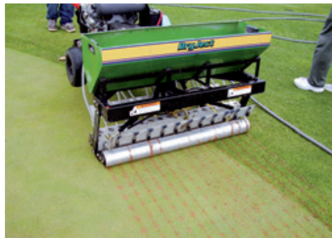
De DryJect is een machine die door Arwin Verschoor wordt geïmporteerd. Zoals de naam al zegt injecteert die droge materialen in de grond, tot 20 cm diep. En dat kan ook een zeoliet of een mengsel van zand met zeolieten zijn.
