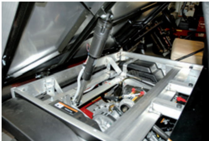
Van de lichte voertuigen is het kipsysteem vaak elektrisch. Het lijkt op een cilinder maar in werkelijkheid is het een draadspindel op een elektromotor. Een hydraulisch kipsysteem zal eerder worden toegepast naarmate de benodigde hefkracht groter wordt.
