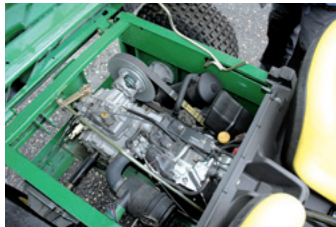
Een CVT aandrijving, het principe van de DAF, zorgt voor een traploze transmissie en is algemeen bij lichte transporters. Vaak is er wel een tweede of derde trap te schakelen om het snelheidsbereik te vergroten. Een CVT maakt het rijden en ook het onderhoud heel eenvoudig.
