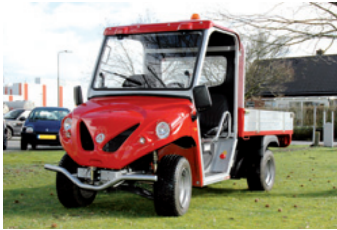
Alké is typisch gebouwd als een transporter en is er met 1,30 of 1,80 m laadvloer. De rijnsnelheid is maximaal 40 km/h, elektrisch is dat 30 km/h.
