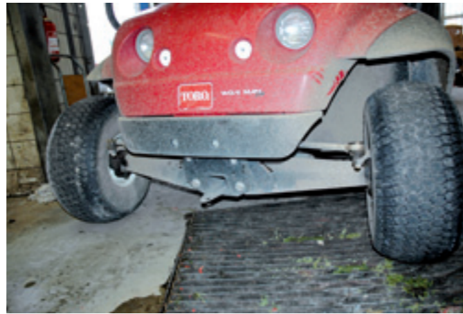
De achteras van de Workmaster is star gemonteerd, de vooras is geveerd, maar ook op erg ongelijk terrein blijven de wielen alle vier goed aan de grond door het scharnierende frame.
