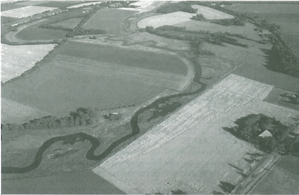
Figuur 2 Hermeanderingen binnen het beekdal van de Ruiten Aa. Het "Noaberpad" bij Renneborg / Wollinghuizen (bron: Hotel de Waalehof, Jipsinghuizen).
