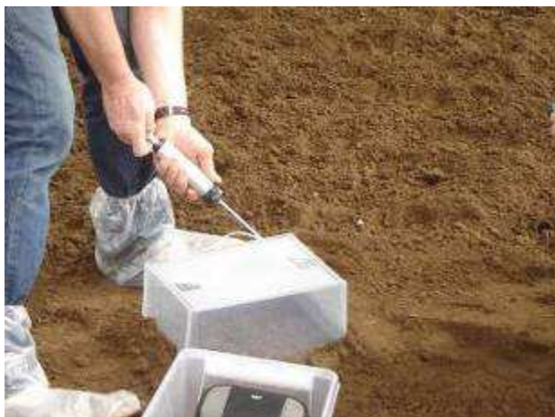
Foto 6 De 'omgekeerde emmer' methode voor het vaststellen van de gasconcentratie
