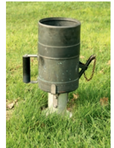
Plastic of glazen regenmeters vangen te weinig water op. Een goede regenmeter heeft een opvangopening van 200 cm 2 en is zo geconstrueerd dat er vrijwel geen water kan verdampen.
