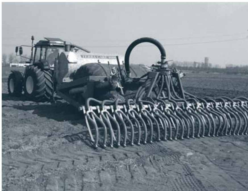
Sleepvoetmachine. Mestinjectie op grasland komt de laatste jaren vrijwel niet meer voor. Veehouders zijn geleidelijk overgegaan op zodenbemesting of werken met de sleepvoetmachine. Deze laatste mag u voorlopig alleen nog gebruiken op klei- en veengrond mits de mest wordt verdund met water.
