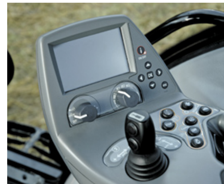
▲ Het display en de knopjes rechts assisteren bij de bediening van de traploze transmissie. De hoofdbediening loopt echter via een rijpedaal (voorheen gaspedaal). Het hendeltje is voor de hydrauliek.
