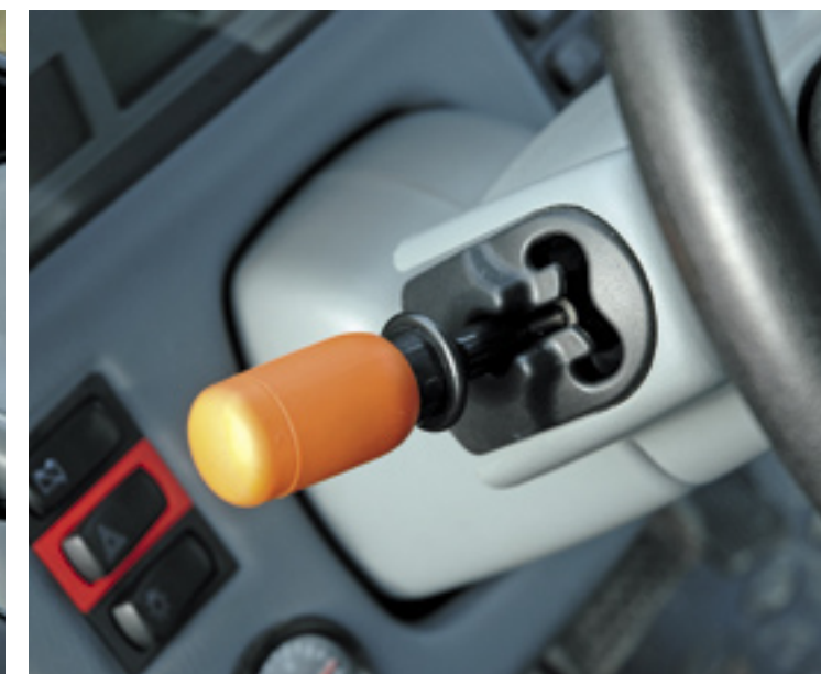
▲ De bekende Valtra-hendel links onder het stuur voor voor- en achteruit (inclusief parkeerrem) is bij de nieuwe S met de traploze transmissie, die ook in Fendt en Massey Ferguson zit, gebleven.
