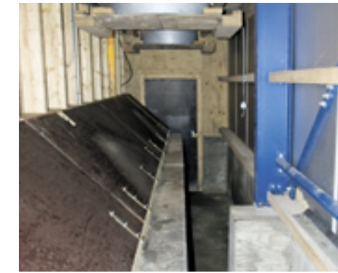
In deze drukkamer is gekoelde of ongekoelde buitenlucht aan te zuigen.
