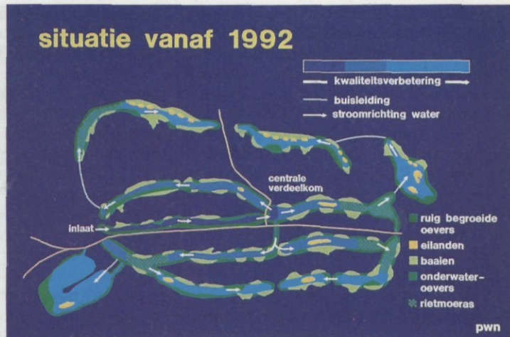
Afb. 2 - De nieuwe situatie van het infiltratiesysteem (de lijn zuid-noord is van links naar rechts).
