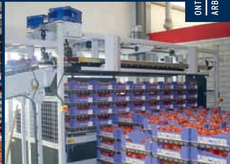
De ontstapelaar van Bogaerts pakt de bovenste laag fust van de stapels en plaatst deze op een band naar de afwegers.
