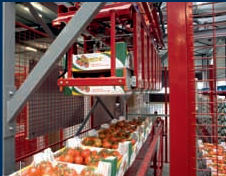
De ontstapelaar van Taks pakt een of twee lagen dozen of kratten van de oogstwagens en zet deze op de ontstapelband zodat het fust één voor één naar de sorteerdere gaat.
