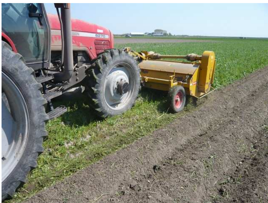
Figuur 26. Verkleinen van de groenbemester met een loofklapper voorop de trekker en de frees er achter.
