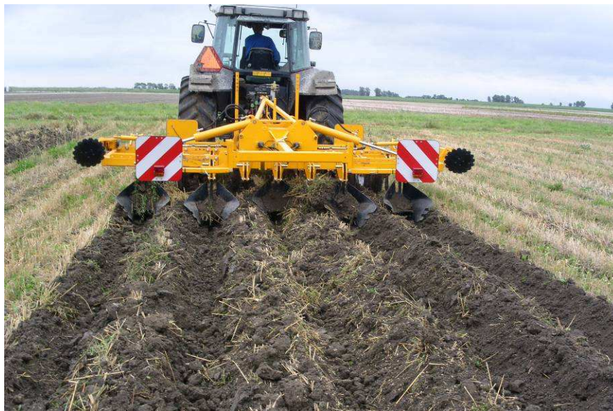
Figuur 8. Na aanpassing van de machine werden nette ruggen gevormd.
