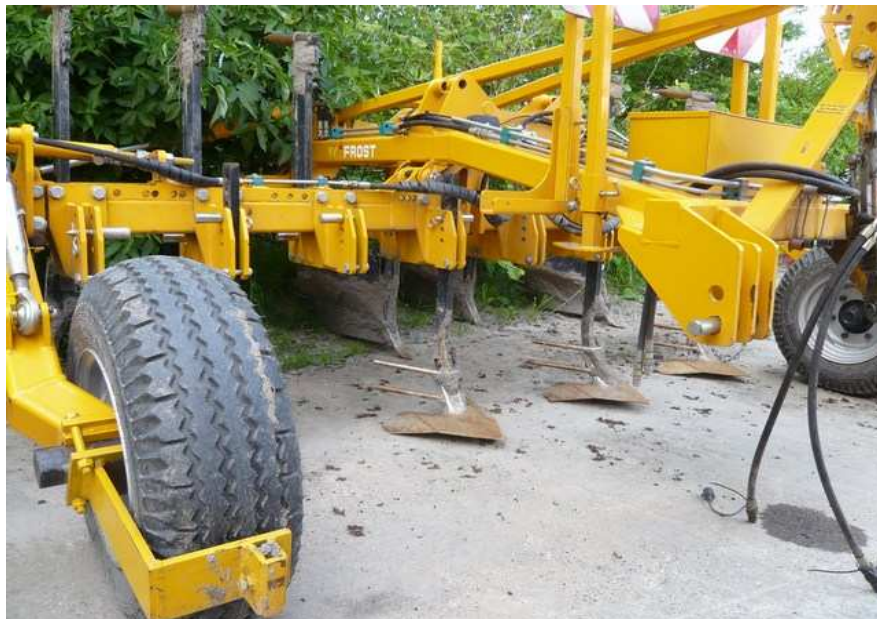
Figuur 16. FROST machine met ganzenvoeten en strijkers (rugbrekers, Dammschäler) om ruggen te splitsten
