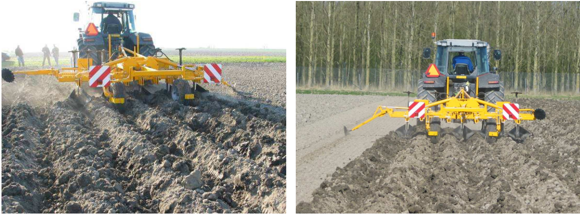
Figuur 3. Ruggen gevormd met een smalle afstelling van de aanaarders (links; brede basis van de ruggen en diepe geulen) en met een brede afstelling van de aanaarders (rechts; smallere ruggen met minder diepe geulen).
