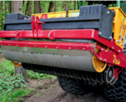
Een grote, zware rol vlakkt het veld. Een schraper aan de achterkant houdt de rol schoon.
