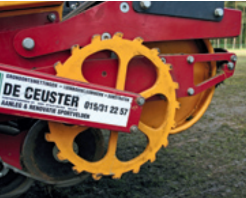
Het stappenwiel drijft het nokkenrad van de zaaimachine aan.
