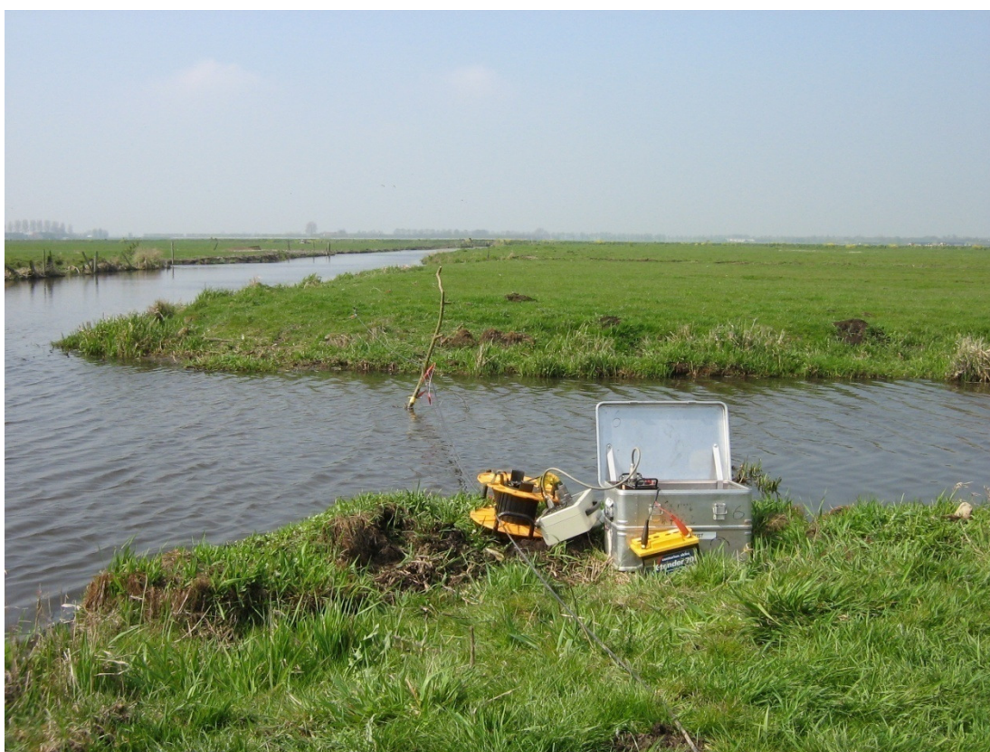
Figuur 2.2 Voorbeeld van een CVES opstelling. In dit geval op gemeten langs de Middentocht ten westen van de Hoofdtocht.
