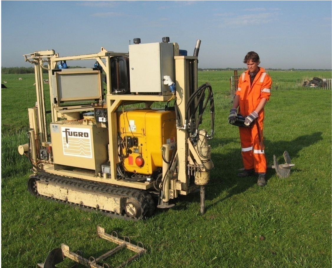
Figuur 6.5: Sondering met mini-rups
