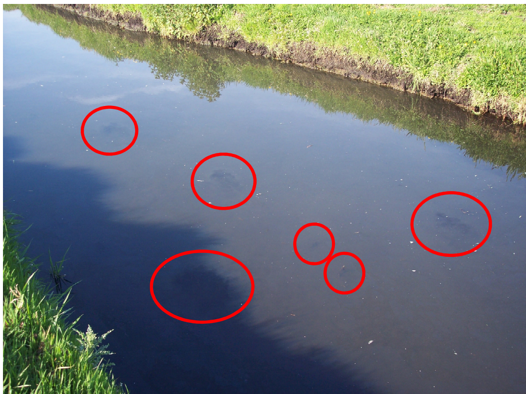
Figuur 5.2. Waargenomen wellen in de perceelsloot. De diameter van deze wellen is maximaal enkele centimeters.
