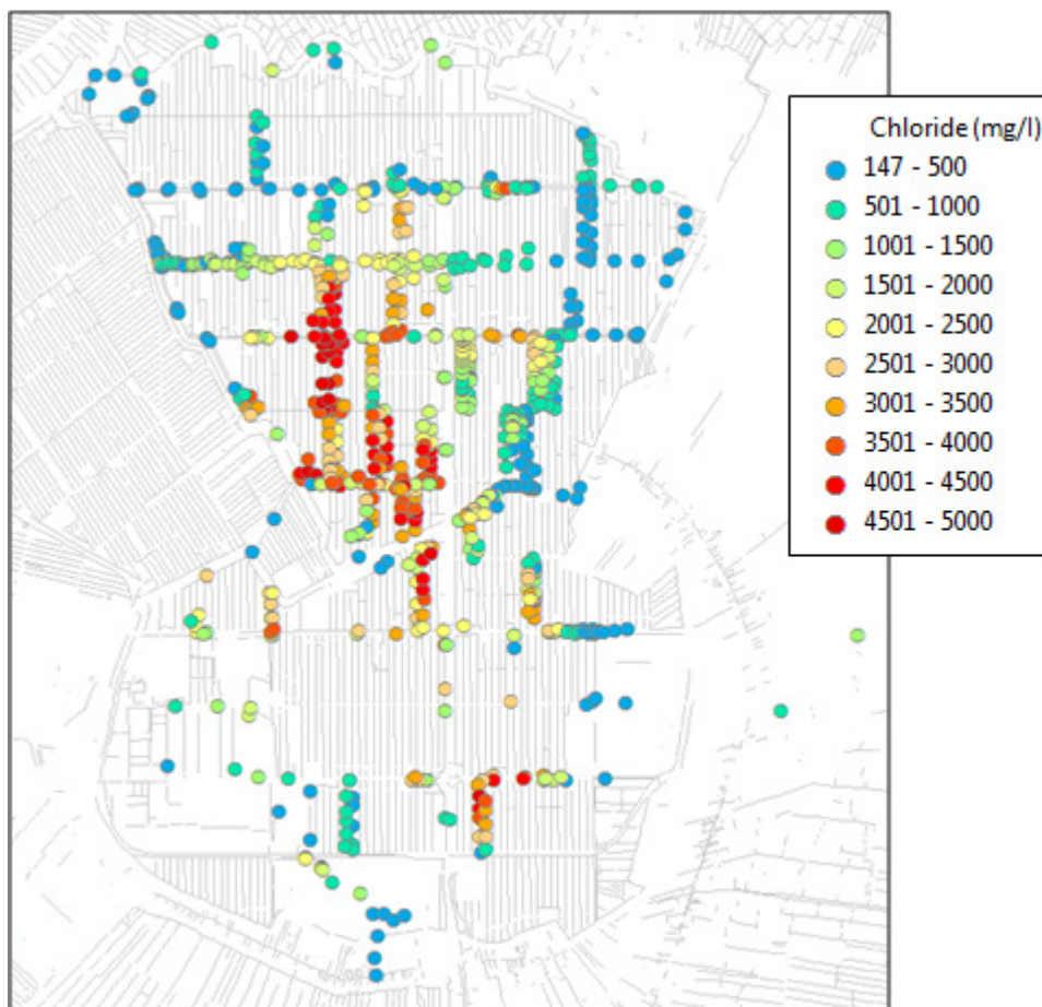
Figuur 4.6. Chlorideconcentraties oppervlaktewater afgeleid uit geleidbaarheidsmetingen.
