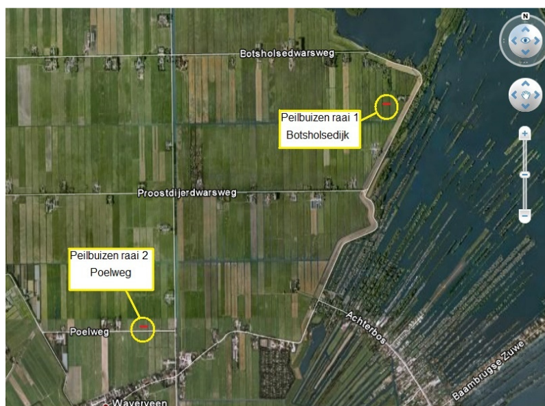
Figuur 6.1. Raaien met peilbuizen in Holocene deklaag.
