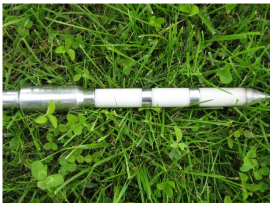
Figuur 3.1. Uiteinde van de prikstok met sensoren.
