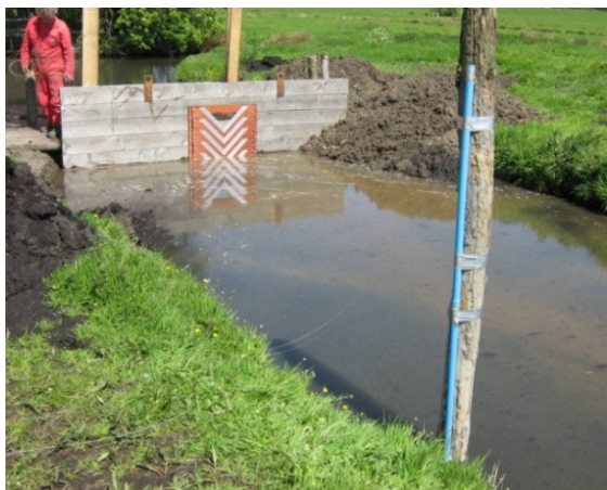
5) Circa 10 m stroomopwaarts van de meetschotten is een peilschaal en peilbuis met drukopnemers (Micro-Diver en Baro-Diver) geplaatst om het waterpeil te monitoren.
