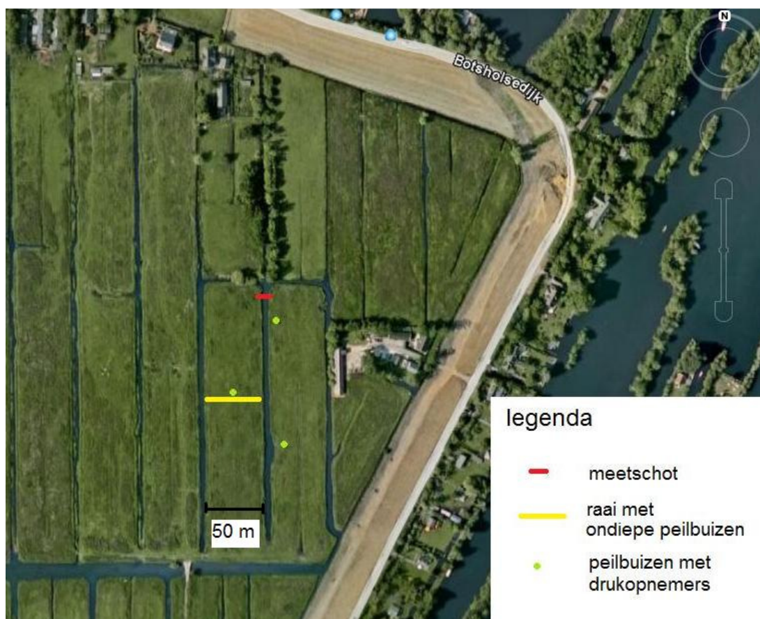
Figuur 5.4: Detail locatie meetschot en peilbuizen.
