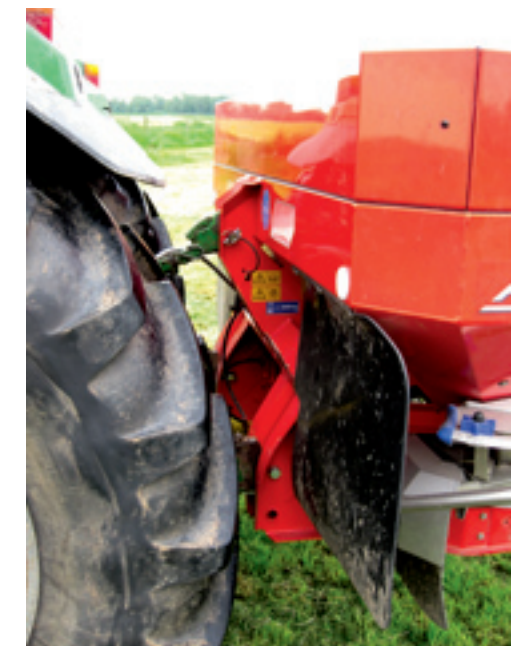
▲ De strooier heeft twee kunststof flexibele spatlappen. Deze zijn tegenwoordig van hard kunststof.
