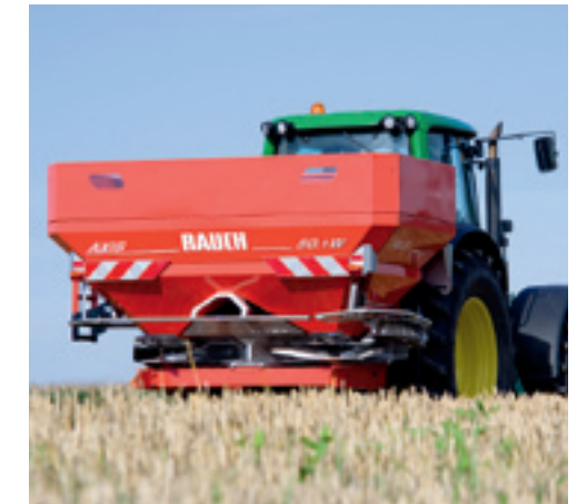
▲ PPO in Lelystad gebruikt de Axis 50.1 sinds najaar 2008. Deze capaciteitsstrooier heeft een werkbreedte van 50 meter en een bakinhoud van 4 ton.
