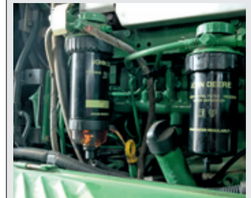
▲ Twee nieuwe brandstoffilters op de 6630 zijn de stille getuigen van de problemen waar Gerrit van Ooijen tegenaan liep.
