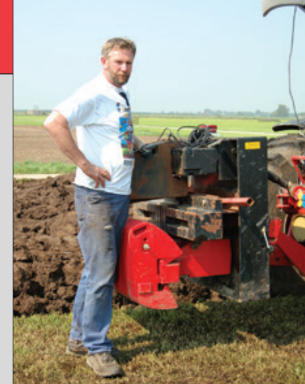
Bij zware werktuigen in de hefinrichting moet je aan de neus van de trekker evenveel gewicht hangen als het gewicht van het werktuig, wil je bij transport veilig rijden. Hans van Leeuwen heeft het frame voorop de XTX aangepast zodat het aantal broodjes snel is te wijzigen.
