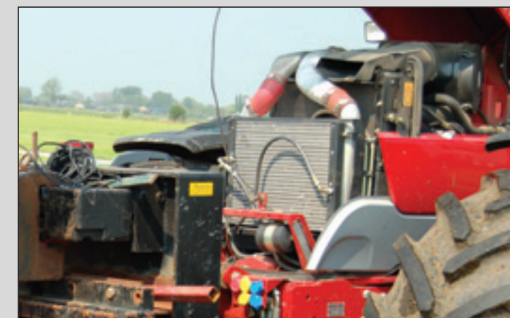
< De motor en koelradiator zijn goed toegankelijk en gemakkelijk schoon te blazen.
