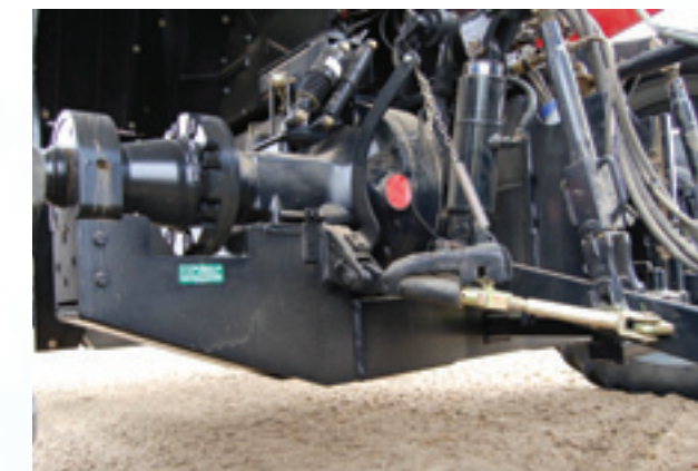
Aan de achteras is een verlengstuk tussen aan de wielens gemaakt en een flinke ondersteuning onder de achterbrug van 20 mm staal.
