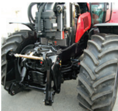
Aan het nieuwe chassis kan een geïntegreerde frontheff.
