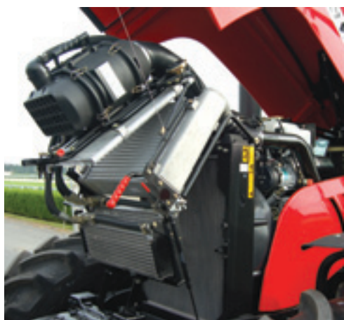
De koelelementen met filter en radiator zijn makkelijk bereikbaar.
