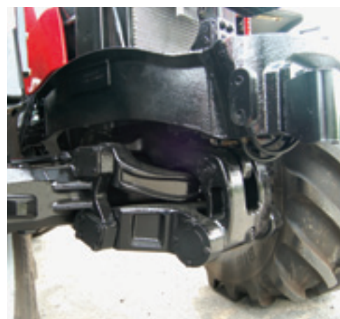
De nieuwe Dana-vooras is compact opgehangen aan het chassis.
