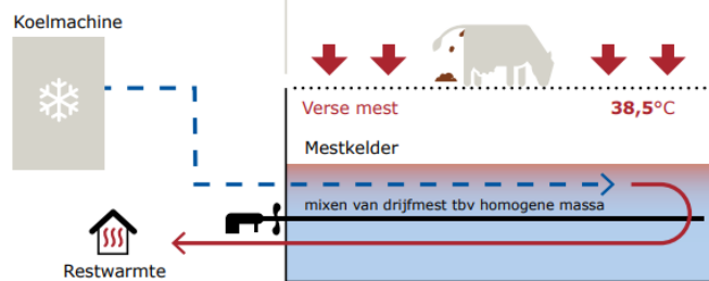
Figuur 2 Gesimplificeerd schema van Mest koelen 2.0 en bereikte gemiddelde temperatuurdaling, case-control.
