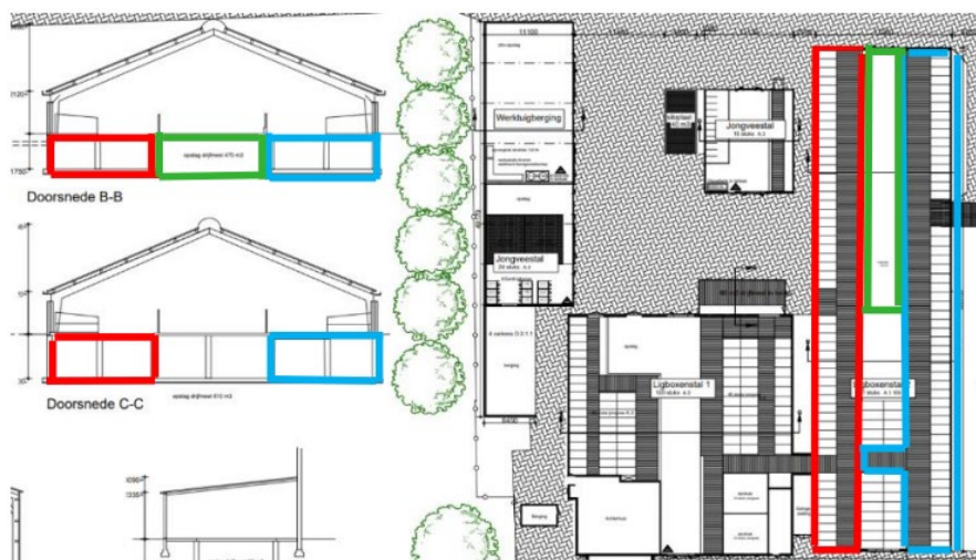
Figuur 3 Doorsnedes B-B en C-C (links) van de stal waar het onderzoek werd uitgevoerd. In de plattegrond van deze stal (rechts) en bij de doorsnedes, in rood de referentie mestkelder en in blauw de gekoelde mestkelder. Groen, niet-gekoelde en niet-onderzochte tussen-mestkelder.
