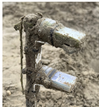
Aan het eind van het seizoen worden de temperatuurloggers weer opgegraven. Idealiter bevinden ze zich nog op maaiveldhoogte en zijn ze niet moeilijk te lokaliseren. Maar soms zijn ze 'koppie onder' gegaan in het sediment en moet de landmeter-GPS eraan te pas komen.
