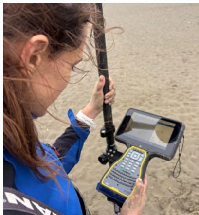
Aan het eind van het seizoen worden de temperatuurloggers weer opgegraven. Idealiter bevinden ze zich nog op maaiveldhoogte en zijn ze niet moeilijk te lokaliseren. Maar soms zijn ze 'koppie onder' gegaan in het sediment en moet de landmeter-GPS eraan te pas komen.
