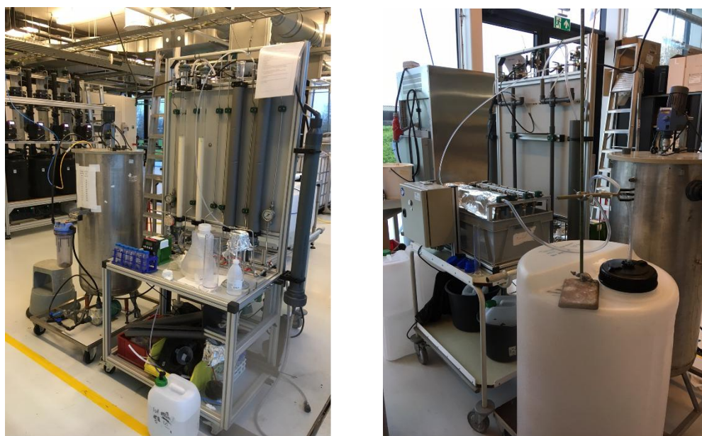
Figuur 5: Kolomexperimenten met de Seplite MA940, bij de 2 e foto het monsternamer apparaat en opslagvat
