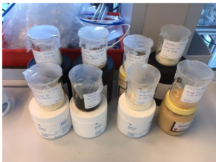
Figuur 4: Foto van de gebruikte en gespoelde IEX typen; voorbehandeling van de IEX voor omzetting naar de Na + vorm
