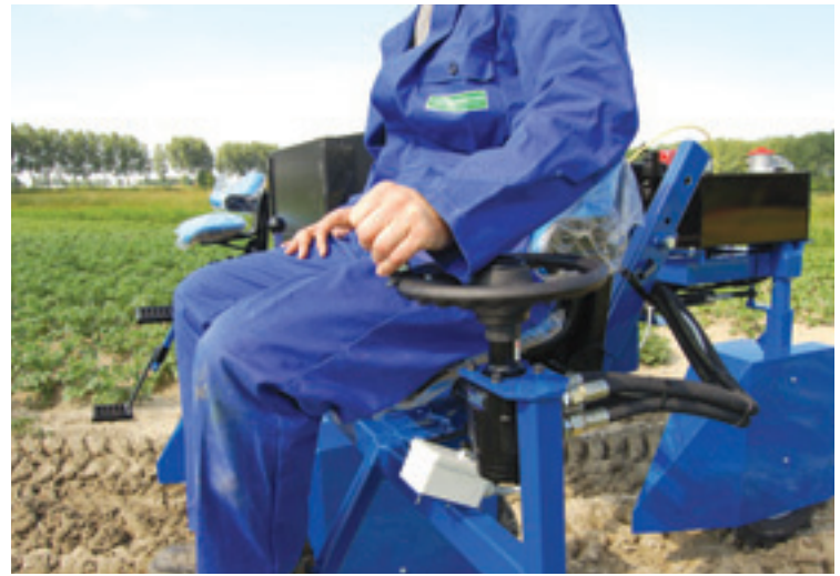
Rechts naast de bestuurder zitten de rijhendel en het gas. Links een klein stuurkje, contactslot en dodemansknop.
