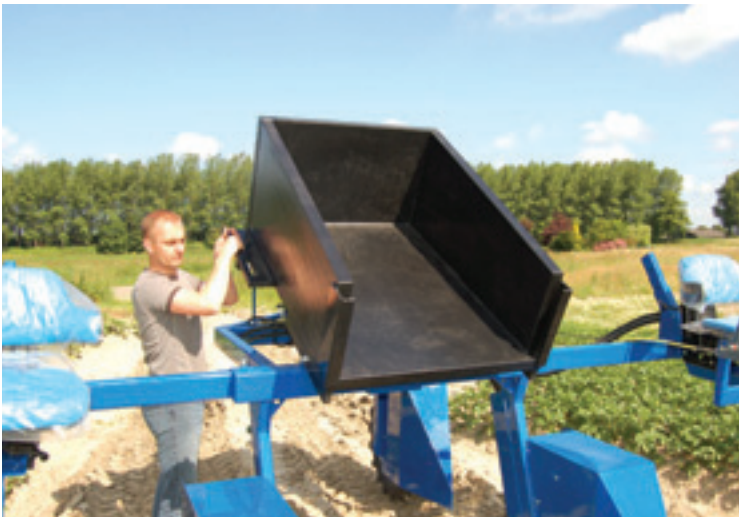
De voorraadbak is van kunststof en heeft 500 liter inhoud. Hij zal duurzaam zijn maar is wel redelijk zwaar om op te tillen.
