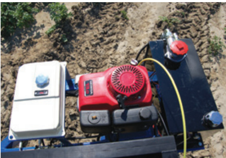
Naast de 13 pk Honda motor zit links een extra benzinetank voor in totaal 13 liter en rechts een tank voor 40 liter hydrauliekolie.
