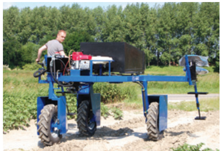
Er is een flinke bodemvrijheid. Schrapers moeten nog worden gemonteerd en de bedrading wordt nog beter afgewerkt op dit prototype.
