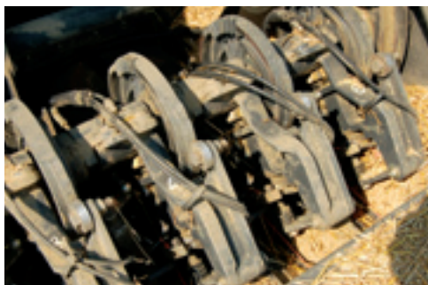
De zes knopers kantelen om de touwspanning te verlagen zodat slijtage wordt voorkomen.
