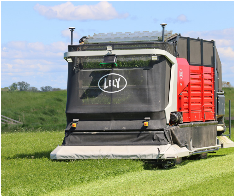
Met een maaibalk en opvoerband vult de robot de voerdoseerwagen.
