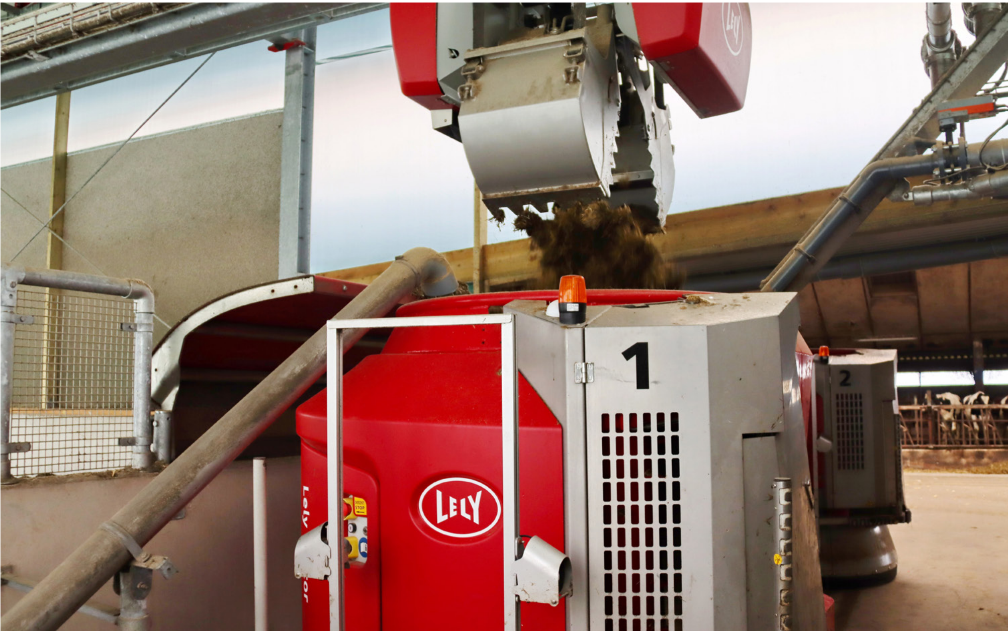
In de voerkeuken vult een gripper de voermengbak met de voorgeprogrammeerde soort en hoeveelheid ruwvoer.
