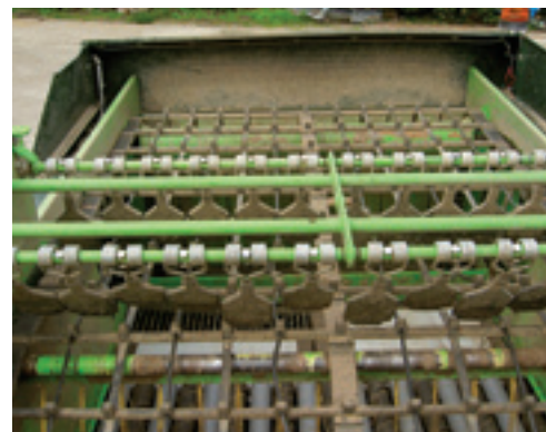
Boven de loofdoorvalmat zijn afstrijkers bevestigd die de laatste aardappelen van het loof afwrijven.
