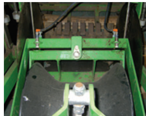
Eén van de twee diabolos kan pendelen zodat deze de rug blijft volgen. De twee sensoren zorgen ervoor dat de stand van de dissel steeds wordt gecorrigeerd.
