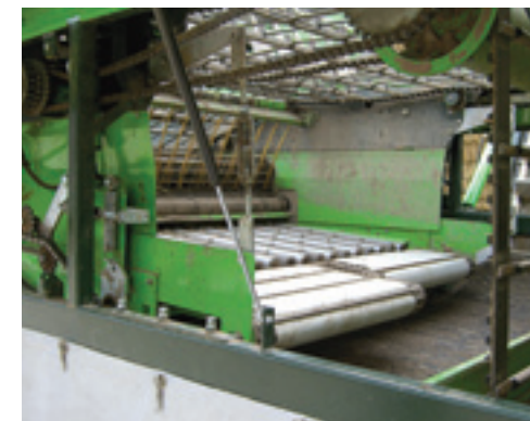
De aardappelen komen vanaf de laatste rooi-mat via de loofrol, de gewone rol, de axiaalrollen en de verdeelbandjes op de spijlenband terecht.
