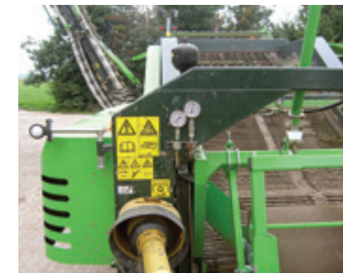
De twee manometers voorop de rooi-er zijn voor de druk op de diabolos en de werkdruk van de machine.
