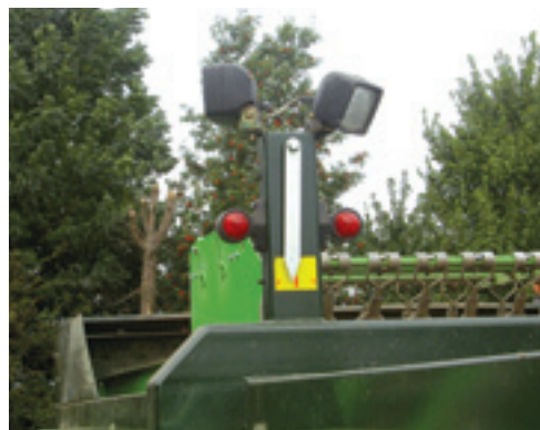
De optische verlichting bovenop de rooi-machine geeft aan hoe ver je kunt uitwijken met de trekker bij het verstekrooien. De aanwijzer is voor de vlakstelling.
