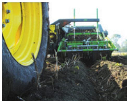
Met de Esprit Wagenrooier kun je ook in verstek rooien. De aansturing van de Esprit gaat via de joystick op de rechter armleuning en het bedieningspaneel.
