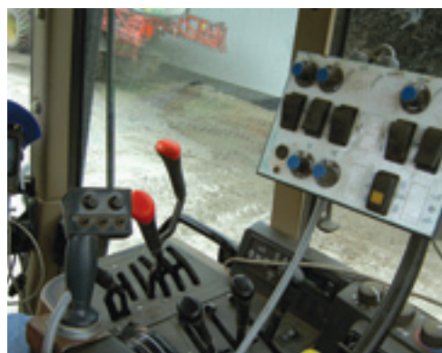
Met de Esprit Wagenrooier kun je ook in verstek rooien. De aansturing van de Esprit gaat via de joystick op de rechter armleuning en het bedieningspaneel.
