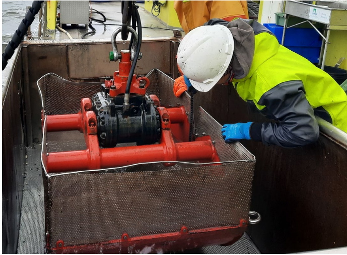
Figuur 7: Hydraulische happer, met behulp van een maatstok wordt de afstand tussen het sediment en de bovenkant van de happer opgemeten.
