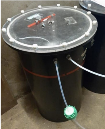
Figuur 6 Meetopstelling geurmetingen. Container met 40 liter monsternazak met aangekoppeld een Teflon leiding met een stoffilter (foto uit Groenestein et al. (2011)).
