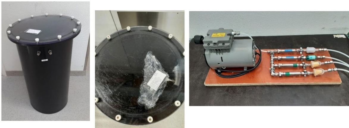
Figuur 5 Meetopstelling van de longzakmethode. Links: Container met 40 liter monsternamezak. Midden: Een vacuüm getrokken 40 liter monsternamezak. Rechts: pomp, monsternameleiding en kritische openingen (foto's van Groenestein et al. (2011)).
