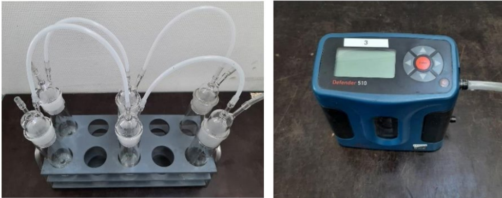
Figuur 4 Meetopstelling ammoniakmetingen. Links: Wasflessen. Rechts: Flowmeter (foto's uit Groenestein et al. (2011)).
