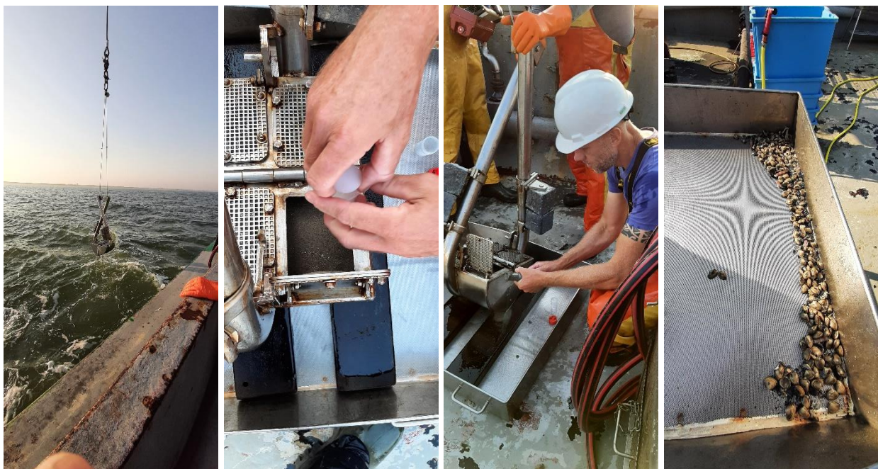
Figuur 7: Van links naar rechts: Van Veen-happer met het monster; nemen van een sedimentmonster uit de Van Veen; Uitstorten van het monster over de zeef en een uitgezeefd monster.
