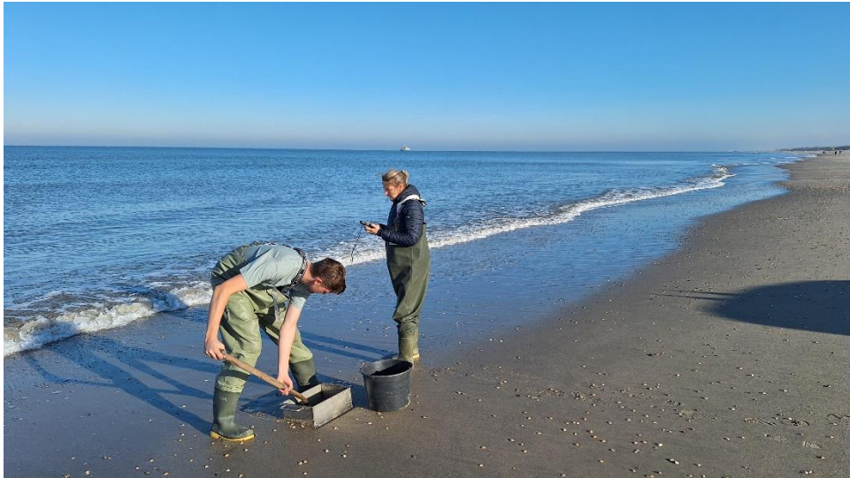
Figuur 10: Nemen van het monster met het RVS frame. De bemonsterde locatie wordt vastgelegd op een handheld GPS.
