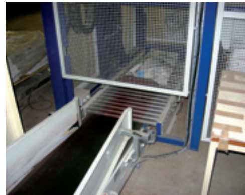
De te stapelen zakken, in dit geval zaai-zaad van de Agrarische Unie uit Emmeloord, komen vanaf de zijkant over een losstaande vlakke band en een geïntegreerde rollenbaan naar binnen. Vaak komen de zakken rechtstreeks vanaf een naaistraat.
