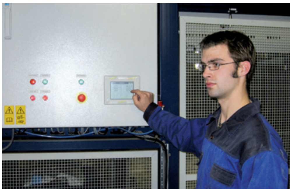
Pieter Goelema, medewerker van de Agrarische Unie, bedient de machine met het touchscreen. Hiermee is de machine in te stellen. Je kunt onder andere kiezen uit tien verschillende stapel patronen.
