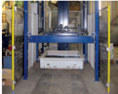
De VPM 500 is qua constructie zeer eenvoudig: een hoofdframe met verticale zakkenlift, een grijper-manipulator en een verstelbare stapelkraag voor alle palletmaten. Twee fotosensoren tussen de gele palen zorgen voor de inloopbeveiliging.
