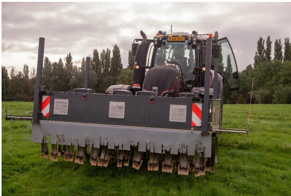
Figuur 17 Een in Duitsland ontwikkelde machine (Zasso Electroherb) voor de elektrocutie van onkruid, in dit geval de spruiten van lidrus (foto Pedro Janssen).
