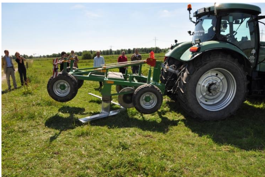
Figuur 18 Een in Duitsland ontwikkeld apparaat (Duwockschneider) voor het horizontaal doorsnijden van wortelstokken van lidrus met behulp van een in diepte verstelbaar stalen mes in V-vorm (foto Agrartechnik GmbH Dröppelmann). Deze machine is echter niet geschikt om in te zetten op bodems met zware kleilagen.
